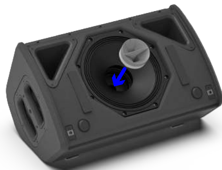
Une fois la grille retirée, un pavillon magnétique optionnel peut rapidement être installé de manière à changer la directivité pour passer de 100° x 100° à 110° x 60°
