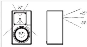
Les pavillons asymétriques situés dans les enceintes ePS sont conçus de manière à ce que la couverture verticale soit plus étroite au dessus de l'axe du pavillon qu'en dessous. Le pavillon pouvant être tourné facilement, il permet à l'utilisateur d'obtenir une directivité optimale pour chaque installation fixe.
