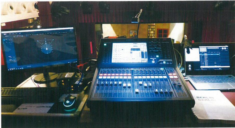
Installée au fond du balcon, la régie compte une QL1, un ordinateur pour QLab et le processeur SPAT Revolution.
