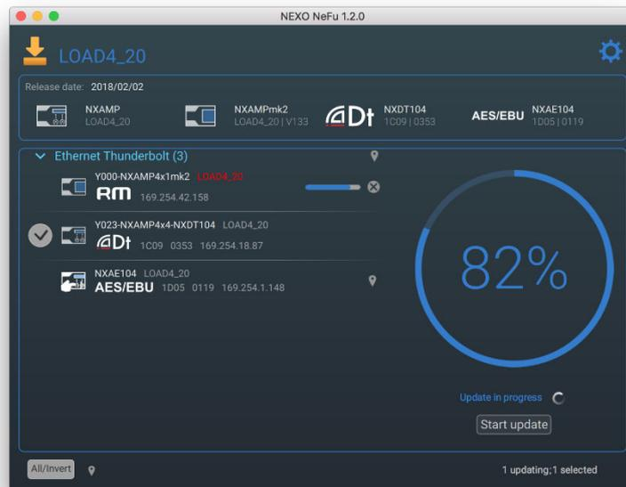
NEXO NeFu est le logiciel de mise à jour du firmware NEXO pour les appareils NEXO. Il vous permet de mettre à jour simultanément un ensemble d'amplificateurs (contrôleurs TD alimentés NXAMPmk2 et NEXO NXAMP).
